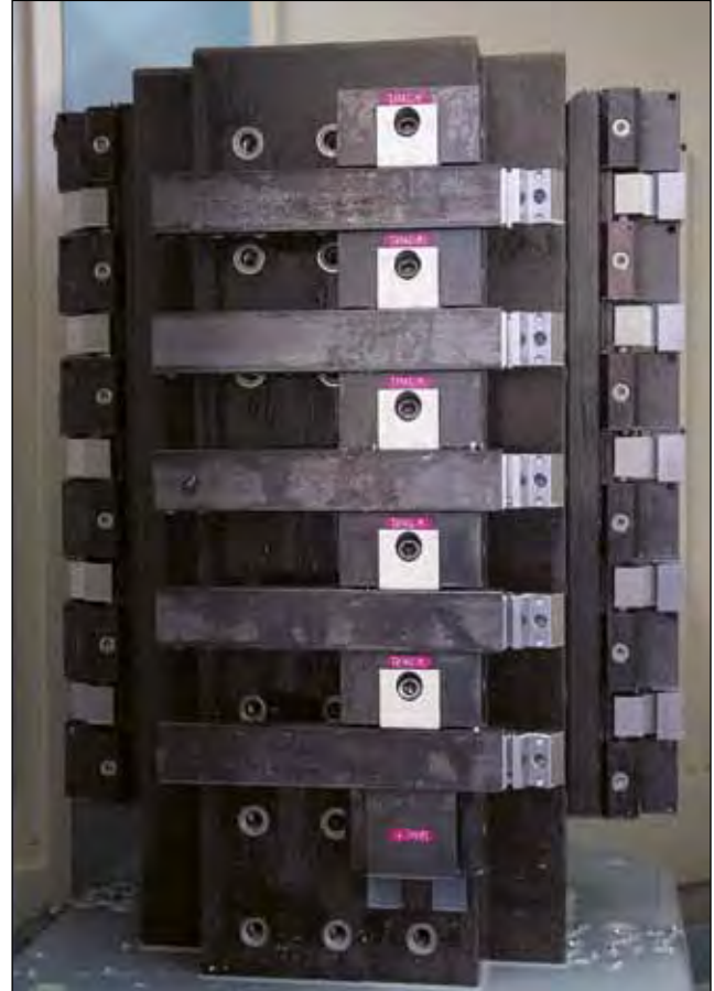
7 Aufspannung mit Power Clamp auf einem „Tripoly“ Mineralgussturm Set up with Power Clamp on a tombstone made of composite concrete Serrage Power Clamp sur une tourelle à minérale coulée
