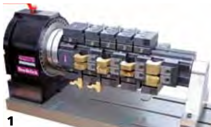
2 Bild 2. Kleinserienfertigung auf Horizontalmaschinen: Autarke Spannstellen ermöglichen die gleichzeitige, spezifische Fixierung unterschiedlicher Werkstücke.
