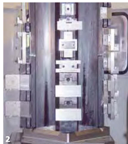
Image 2. Petite série en production sur une machine horizontale: Les positions de serrage autonomes permettent simultanément des fixations spécifiques et des pièces à usiner différentes.
