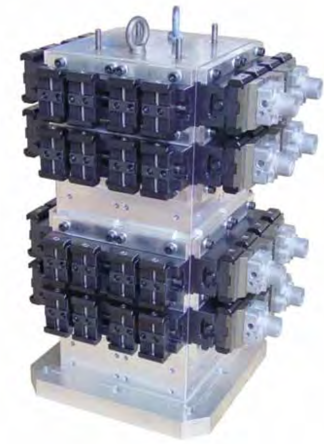
3 Zentrischspanner auf einem Spezialturm Centric vices installed on a special tombstone Module de serrage à centrer sur une tourelle spéciale
