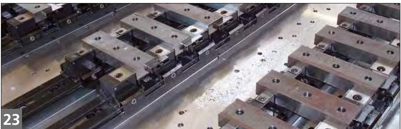
5-Achs Spannen auf einem Lehmann Teilapparat. 5-axis application on Lehmann indexer. Serrage sur diviseur 5 axes.
