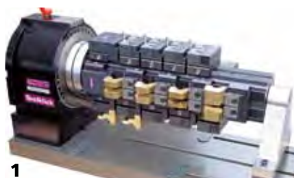
Image 1. Les machines verticales avec une surface de table complète et un système de serrage multiple modulaire garni permettent une densité de serrage qui se ressemble sur les machines horizontales.
