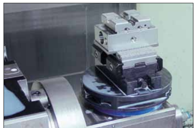
39 oppSystem in Anwendung mit Werkstückwechsler oppSystem in application with workpiece changer oppSystem en application avec le changeur de pièces
