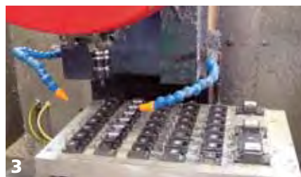
3 Bild 3. Die Verwendung von Mehrfachspannsystemen auch in der Kleinserienfertigung reduziert den Werkzeugwechsel und erhöht die Wirtschaftlichkeit
