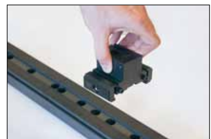
2. Abheben und neu platzieren Lift and change position Enlever et repositionner le module
